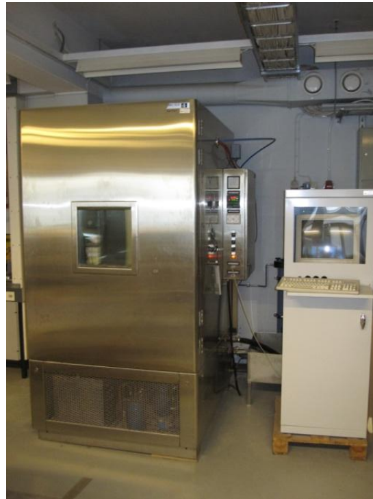
Joonis 3.28. Kliimakamber ARCTEST 1500 (autori foto)
