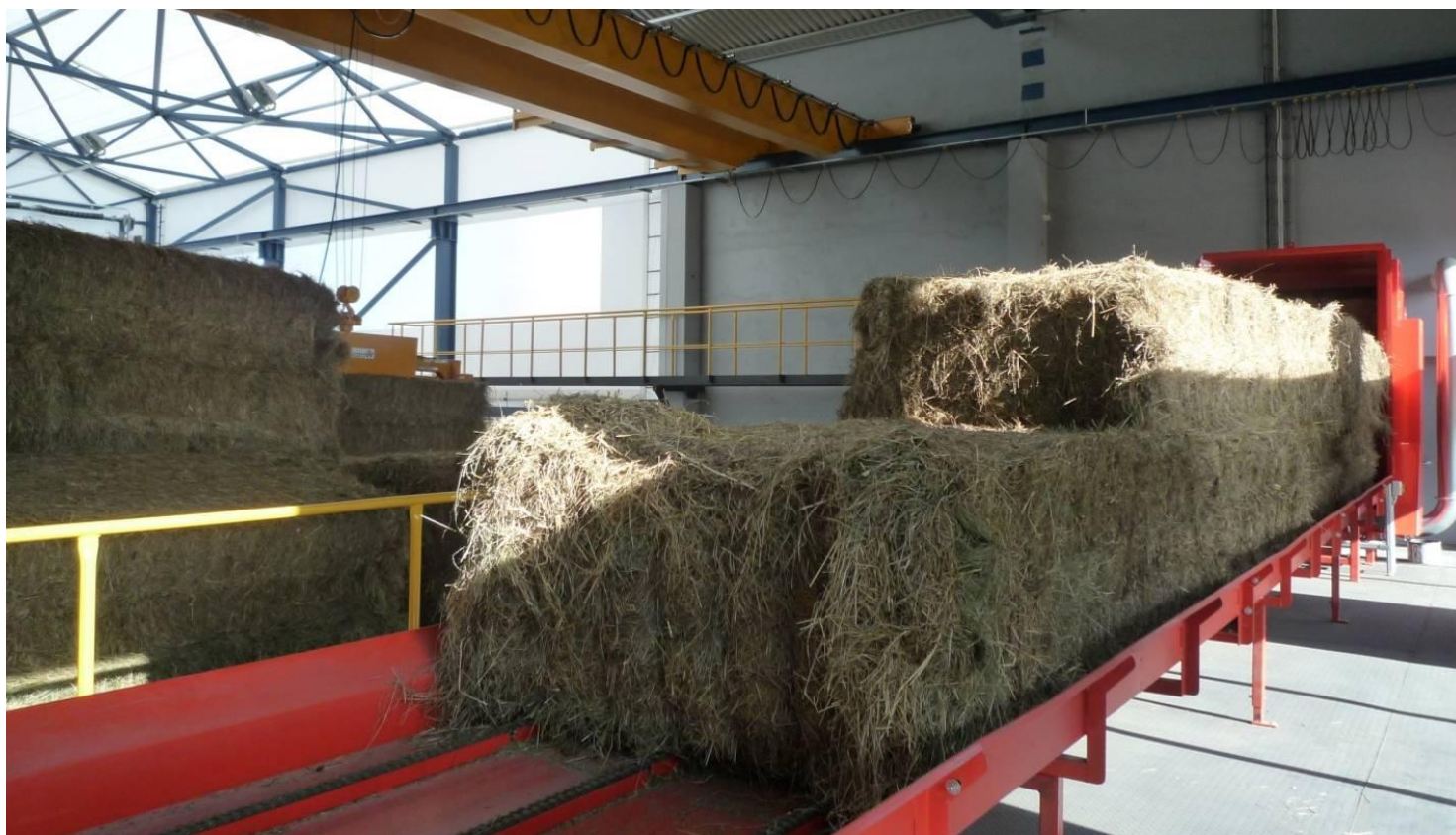
Joonis 4.8. Heina (vasakul) ja pilliroo (paremal) lintkonveier Lihula katlamajas (foto: Ü. Kask)
