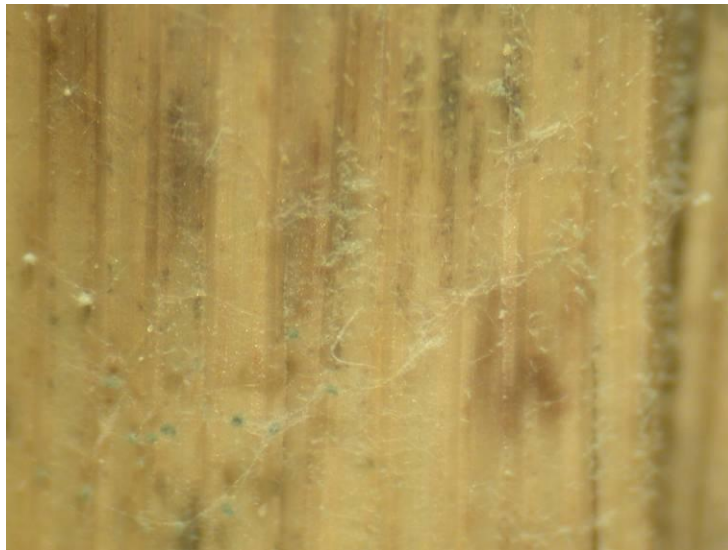
Joonis 3.29. Läbi mikroskoobi pildistatud pilliroost katsekeha, millel on näha mütseel ja hallitusseente koloonia (autori foto)
