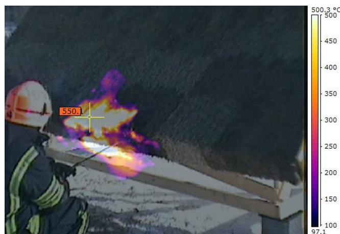
Joonis 3.36. Süütamise ajal katusest 1 soojuskaamera tehtud pilt (autori foto)
