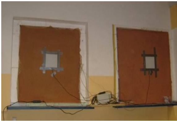
Joonis 3.13. Soojusvooplaadid ja termopaarid seina pinna teperatuuri ja seina soojusjuhtivuse mõõtmiseks (foto: J. Miljan)
