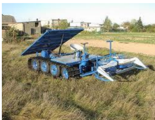
Joonis 3.3. poola Reeda rookombain BCS heedriga (Reeda Reed 2013)
