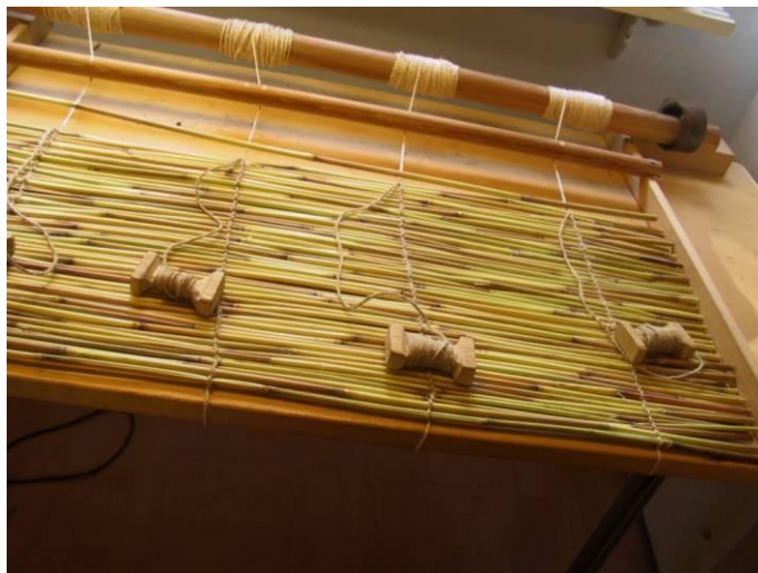
Joonis 7.6. Lihtsad teljed, millega on võimalik kudu- da roomatti või istmekatet (foto: O. Tuomela)
