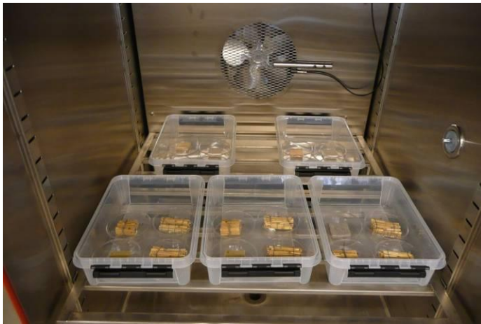
Joonis 3.27. Katsekehad kliimakambris (autori foto)
