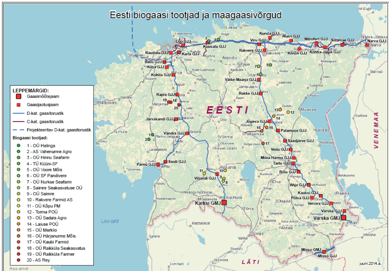
Joonis 3.5. Eesti potentsiaalsed farmi biogaasijaamad kantuna maagaasi magistraaltorustike kaardile (allikas: AS Gaasivõrgud)
