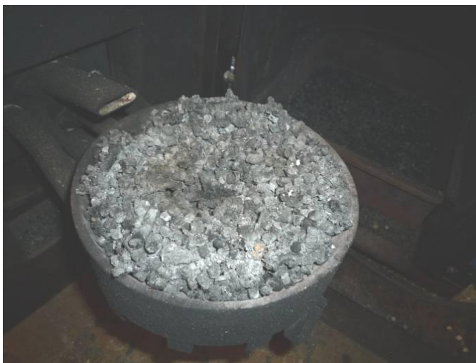
Joonis 4.14. Pilliroo pelletite põlemisjääd pärast põletuskatset (foto: Ü. Kask)
