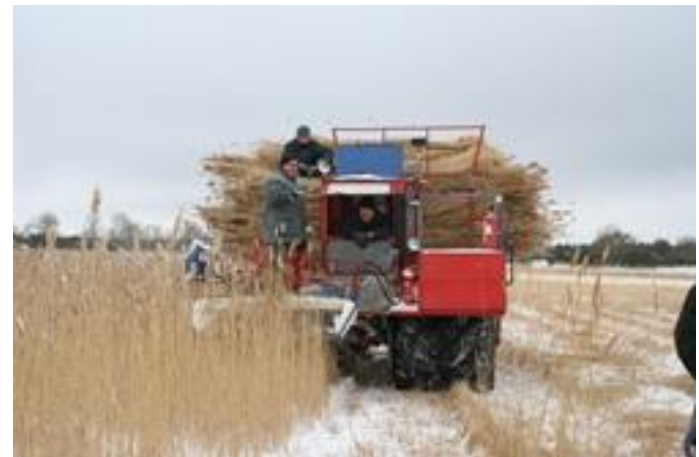
Joonis 5.9. Rookombain Seiga BCS heedriga (foto: Ü. Kask)
