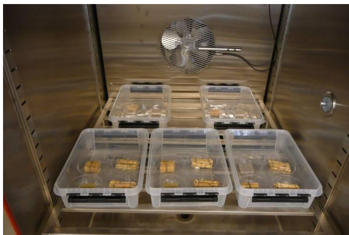
Joonis 3.27. Katsekehad kliimakambris (autori foto)
