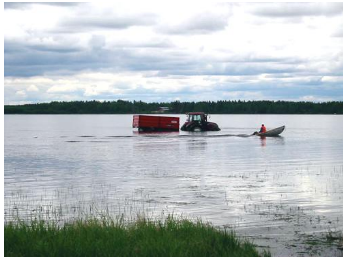
Joonis 5.11. Erivarustusega traktor Valtra C150 koos käruga suudab lõigata roogu järvedel ( http://www.valtra.com/news/405.asp )
