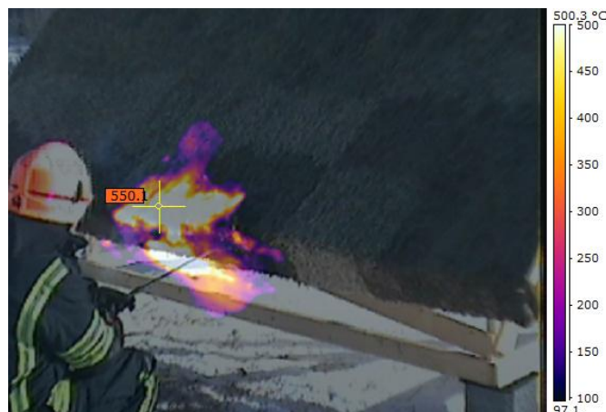
Joonis 3.36. Süütamise ajal katusest 1 soojuskaamera-ga tehtud pilt (autori foto)
