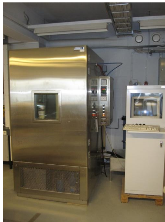
Joonis 3.28. Kliimakamber ARCTEST 1500 (autori foto)
