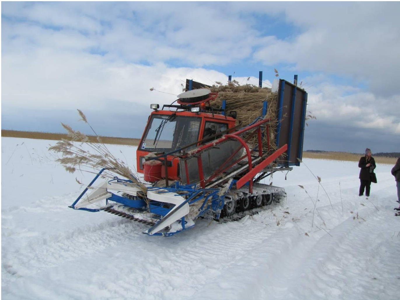
Joonis 3.2. OÜ Järveroog rookombain BCS heedriga rajatraktoril Paan a (foto: K. Akermann)
