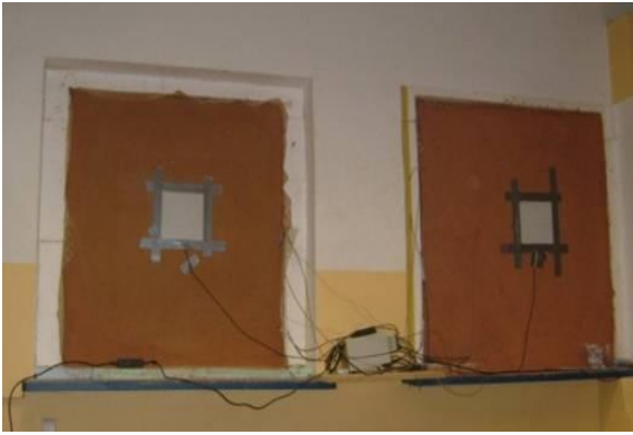
Joonis 3.13. Soojusvooplaadid ja termopaarid seina pinna temperatuuri ja seina soojusjuhtivuse mõõtmiseks (foto: J. Miljan)
