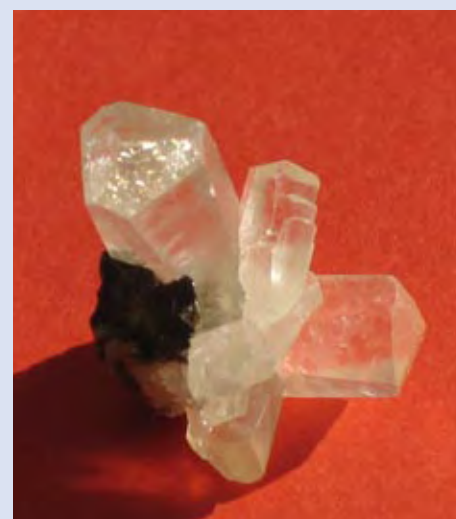
■ Plaatjad ja odakujulised markasiidikristallid püriidi-kaltsiidi soone keskosas põlevkivis (lk 7). ■ The plate-like and spear-shaped crystals of marcasite in the central zone of the pyrite-calcite vein in oil shale (page 7).
