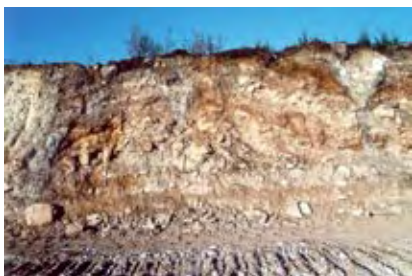
Joonis 3. Savitäitega karstivööndid oksüdeerunud põlevkivis Põhja-Kiviõli karjääris.
