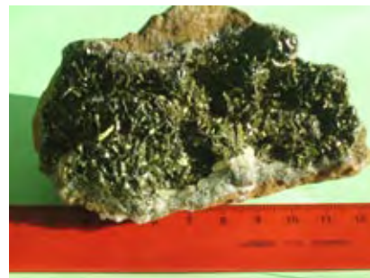
Joonis 5. Plaatjad ja odakujulised markasiidikristallid püriidi-kaltsiidi soone keskosas põlevkivis.
