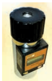
Niiskusemõõtja WILE biomassi niiskuse ekspresshindamiseks.
