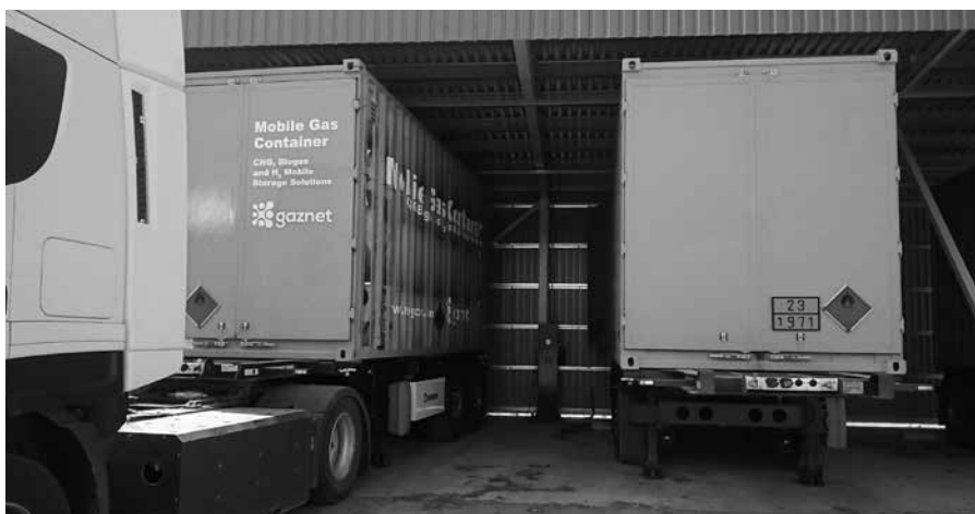
Foto 3: Surubiometaaniga sõitev 410 hj Iveco Stralise veoauto surubiometaanikonteineriga.
