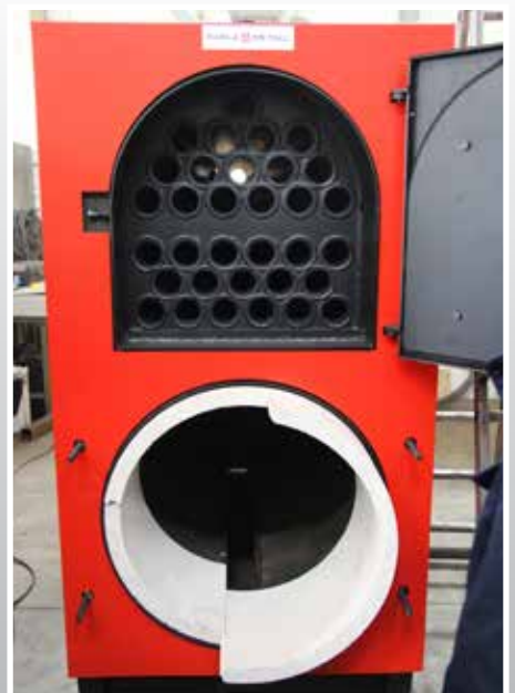
AS-is Rapla Metall välja töötatud pelletikatel.
