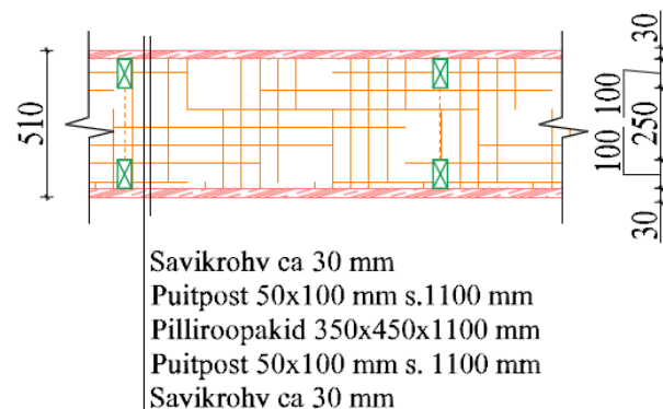
Joonis 4.3. Katsemaja seinte konstruktsioonid (M-J. Miljan 2012)
