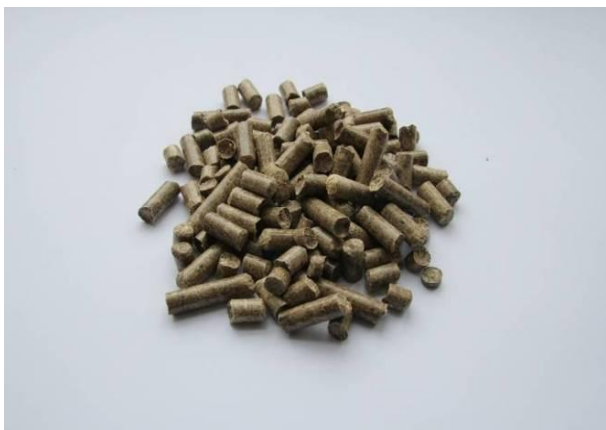
Joonis 6.2. Pilliroopelletid (vasakul) ja pilliroobriketid (paremal) (fotod: Ülo Kask).
