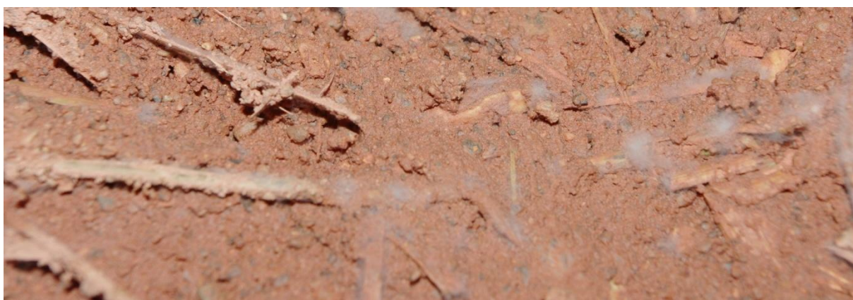
Joonis 3.47. Õrn hallitusekiht hiljuti pillirooseinale paigaldatud savikrohvil (foto: J. Miljan)
