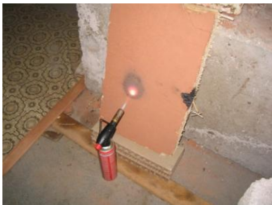
Joonis 3.37. Katsekehale suunatud gaasipõleti leek (foto K. Kuus)
