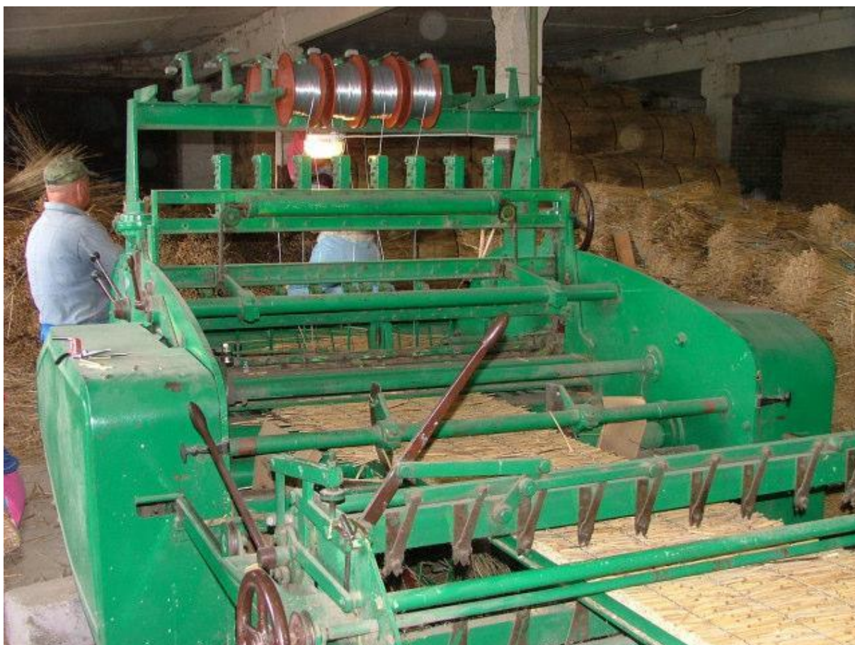
Joonis 3.49. Berger plaate valmistav masin (foto: J. Miljan)
