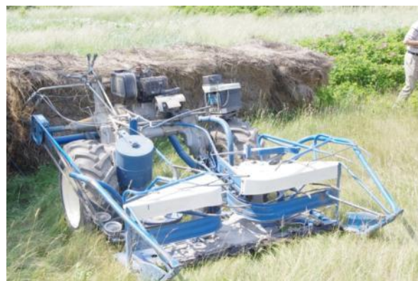
Joonis 2.3. Roolõikur BCS 662, väikseim saadaolev niiduk (foto: M. Miljan)
