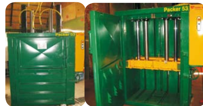
Automaatne prügipress paberi, kartongi ja plast/ kile kokku pressimiseks.
