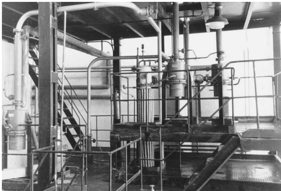
Dikarboksüülhapete dimetüülestrite rektifikatsioonikolonn vastuvõtjatega. Rectification column for dicarboxylic acid dimethyl esters with receivers.
