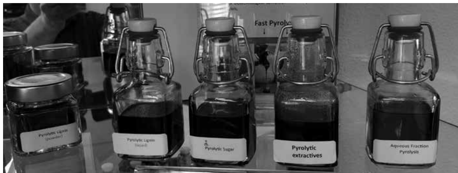
Pürolüüsiõli fraktsioneerimine (BTG Bioliquids BV Hollandis).
