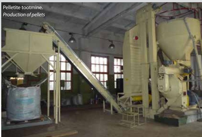
Pelletivalmistamise seade OGM-1,5A. Pellet press OGM-1,5A.
