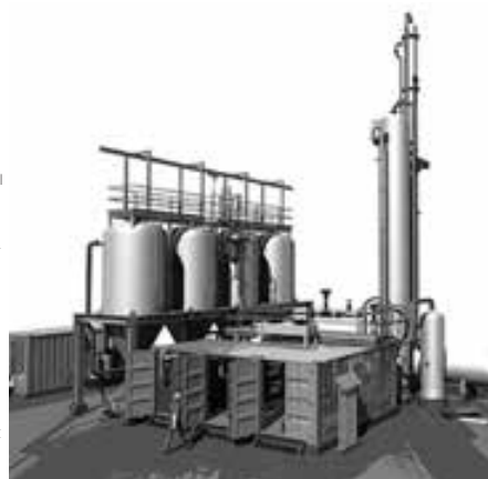
Joonis 4. Keemilise puhastuse seade (nn amiinopesu). Tootlikkuse vahemik 250–2500 Nm 3 /h.
