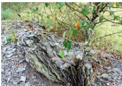
Joonis 5. Näide lehestunud kildast. A sample of foliated dictyonema oil shale.
