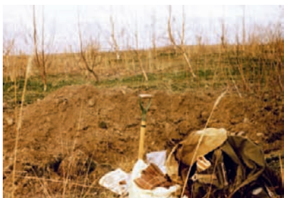
Joonis 6. Tüüpiline proovivõtuala, -auk ja -vahendid tasandatud puistangutega Maardu lõunakarjääris. A typical sampling area and cutting and means for sampling in the southern quarry of Maardu with dumps leveled.
